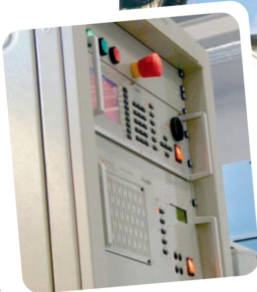
spiel der Spannungsverlauf in einem Netzabschnitt in Echtzeit simuliert und die zu untersuchende Komponente als Hardware in die Simulationsumgebung eingekoppelt“, erklärt Hribernik. „Das kann ein Schaltgerät ebenso sein wie ein Wechselrichter oder auch eine Ladestation für Elektrofahrzeuge.“
